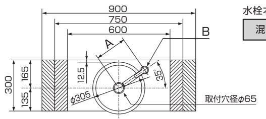
水栓本体の仕様により、A (水栓取付穴中心一排水穴中心)・B (水栓取付穴径) の寸法が異なります。
