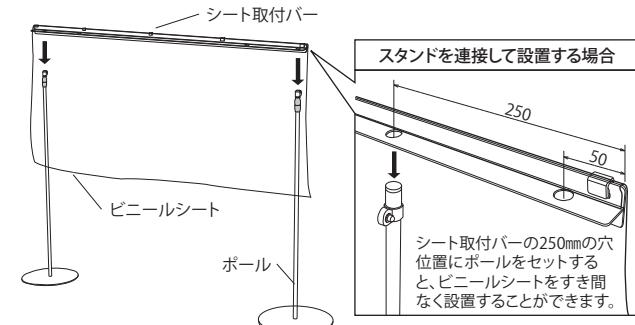
ベースをポールに皿ばねワッシャー・ネジでしっかりと締めて固定します。(ゆるみ防止のため、ポールとベースの固定に固着剤付きネジを使用していますので、いつんネジを締めるとはすしくなります。)
