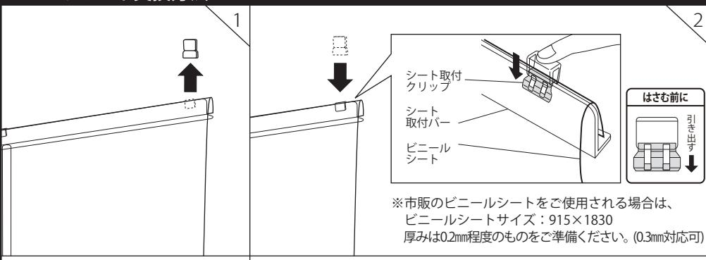
シート取付バーからシート取付クリップを取りはずし、ビニールシートをはずします。新しいビニールシートをシート取付バーの上で折り返し、シート取付クリップを奥まで差し込み、シートを固定します。
