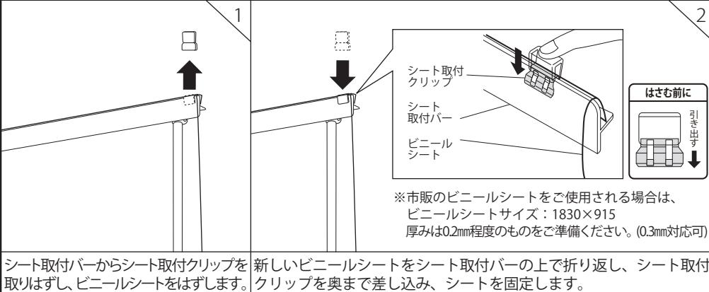
シート取付バーからシート取付クリップを取りはずし、ビニールシートをはずします。新しいビニールシートをシート取付バーの上で折り返し、シート取付クリップを奥まで差し込み、シートを固定します。
