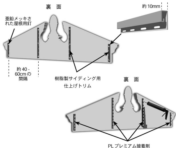
水が背後に浸透しても流れ出るように、クロスヘッドはブリックモールディングの約5mm上に位置付けます。次に、PLプレミアム接着剤と非腐食性の留め金具を使って、クロスヘッドを指定の位置に固定します。
