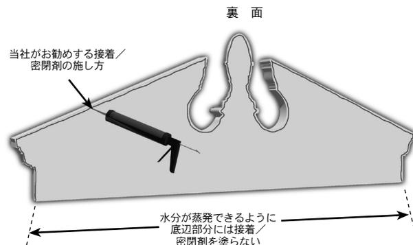
2. ミルワークを取付ける位置を決めます。空洞でない下地材または枠部材が後に取付けられている場合には、ミルワークをそこへ固定します。しかし、そのような部材が背後にない場合には、空壁用の留め金具を使用してください。(図参照)
