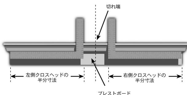
3. 入口の開口部の上に左右のクロスヘッド部材を設置し、クロスヘッドのプレストボード外側の縁が入り口開口部の端、またはピラスターの外側の端と一直線に並ぶように配置します。
