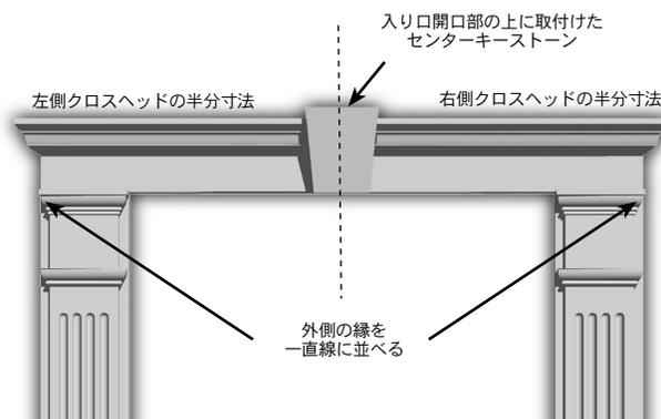
4. クロスヘッドの中央の継ぎ目は、キーストーンを開口部の中央、クロスヘッドの上に取り付けて覆います。PLプレミアム接着剤と留め金具を使って、キーストーンをクロスヘッドに取り付けます。留め金具用の穴はさら穴にし、取付け後に充填材で埋めます。
