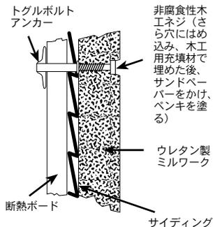
ミルワークは、既設のブリックモールディングと表面が揃うように、取付けることもできます。壁面にしっかり固定するために、非腐食性留め金具とPLプレミアム接着剤を併用します。
