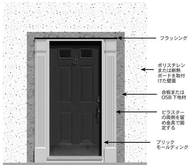
次に、外装用サイディングを取付けます。外装用サイディングとミルワークの間には、約5mmの隙間を設け、非収縮性の上質コーキング剤で隙間を埋めて処理します。
