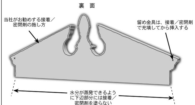
3. ミルワークを壁表面にぴったりと密着させると、接着／密閉剤が端からはみ出てきますから、これを端全体に伸ばし、新たに接着／密閉剤を周辺に塗って、防水バリアーを形成し、十分に風雨から保護します。
