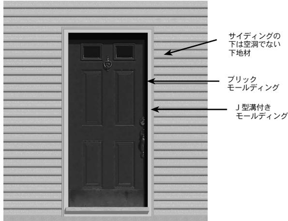
空洞でない下地材または枠部材がサイディングの後ろに取付けられている場合には、ミルワークをそこへ固定します。しかし、そのような部材が背後にない場合には、特殊な留め金具を使用してください。(右図を参照)
