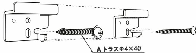
③ ブラケットの高さと水平を調整し、上の穴に A トラスΦ4×40 を締め込んでください。
