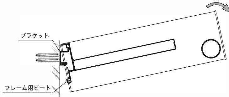
② 斜めに引っかけた状態で、フレームの突起がブラケットの突起に干渉しない位置になるまで、斜めのまま下に下ろす。
