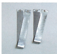
[FTB-A型] ガラスクロス+ アルミラミネート製 (防災1級合格品) 引張強度: 500kg/15mm
